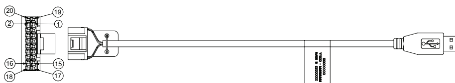
Figura 2-2 Cabo de Programação USB Traseiro 20 Pinos MAP PMKN4148_
